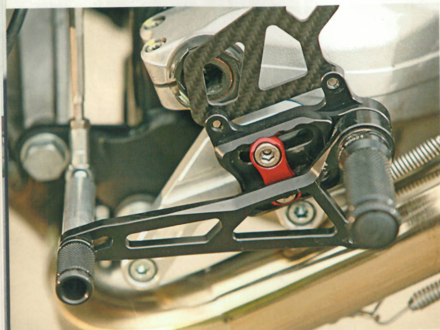
Sportliche Raste. Fein einstellbar und in geringstmöglicher Basisbreite anmontiert
