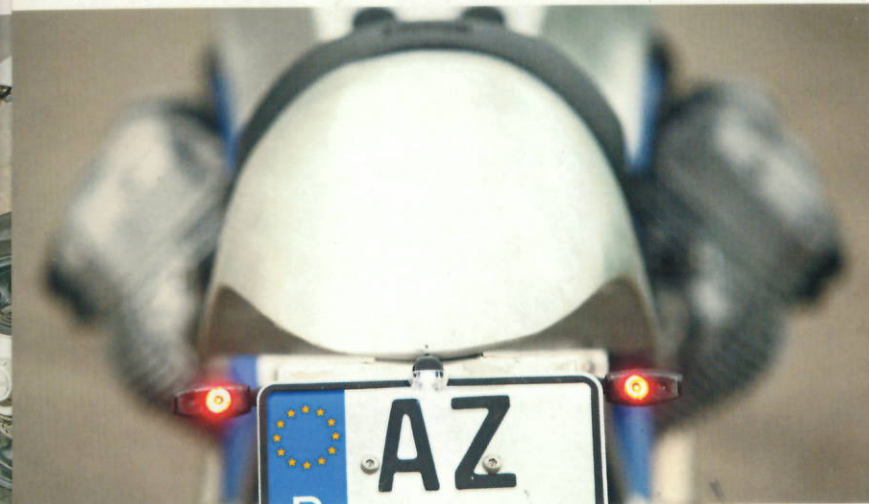
LED-Technik ganz hell und minimalistisch. Blinker und Rückleuchten kombiniert
